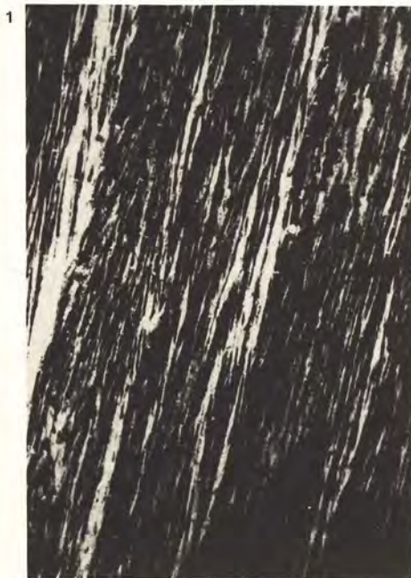
Bild 1: Stark ausgeprägte Textur im Staubansatz der Lüfterschaukeln, gekreuzte Polarisatoren, Maßstab 60:1.
