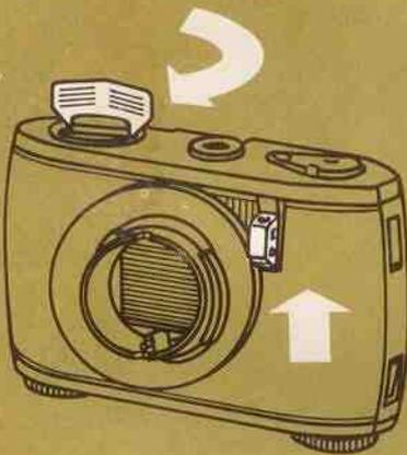
6) Nach jeder Belichtung wird die Transportsperre niedergedrückt und der Film mit dem Schnelltransportschlüssel weitertransportiert. Die Zahl der belichteten Aufnahmen kann durch die Lupe am Bildzählwerk abgelesen werden.
