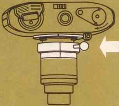
5) Verbindung zwischen Kleinbildkassette und Objektivstutzen.
